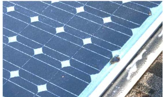
**En el sentido del reloj, desde arriba a la izquierda: marca de quemadura y vidrio astillado en el frente del panel, caja de conexión quemada en la parte de atrás del panel, daño de la caja de conexión en la parte de atrás del panel y marca de quemadura (sin vidrio astillado) en el frente del panel.**
